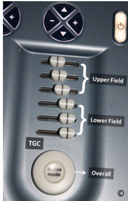
Hình 2.12: Bù gain theo thời gian (TGC) trên bàn điều khiển máy siêu âm. Những nút phía trên (upper field) và phía dưới (lower field) điều chỉnh độ sáng theo thứ tự. Nút chung (overall) giúp chỉnh sáng – tối toàn màn hình.
