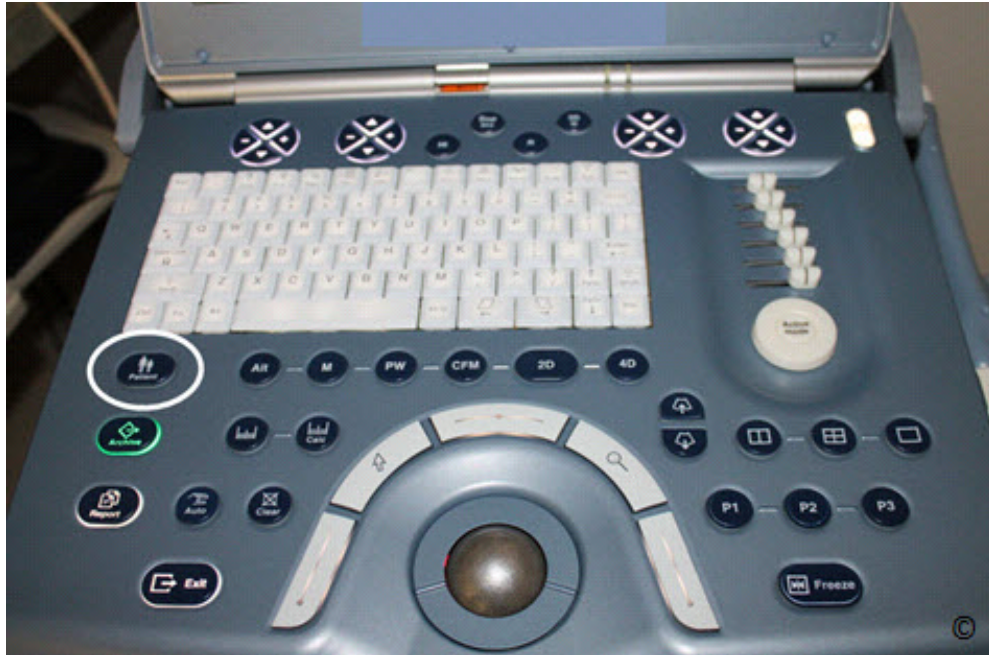
Hình 2.18: Bàn điều khiển của một máy siêu âm có nút “Patient” (vòng trắng), giúp bạn điền thông tin trên màn hình (không hiển thị ở đây) nơi thông tin của bệnh nhân được nhập vào trước khi tiến hành siêu âm.
